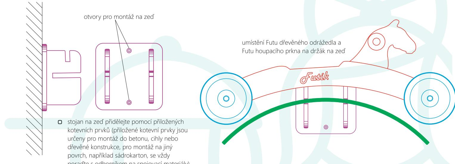
□ stojan na zeď přidělejte pomocí přiložených kotevních prvků (přiložené kotevní prvky jsou určeny pro montáž do betonu, cihly nebo dřevěné konstrukce, pro montáž na jiný povrch, například sádrokarton, se vždy poraďte s odborníkem na spojovací materiály)
